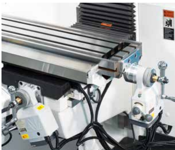
Caja electrónica de avances para los ejes X e Y Electronic power feed for X and Y axes Elektronischer Vorschubkasten für die X- und Y-Achsen Boîte électronique d'avances pour les axes X et Y
