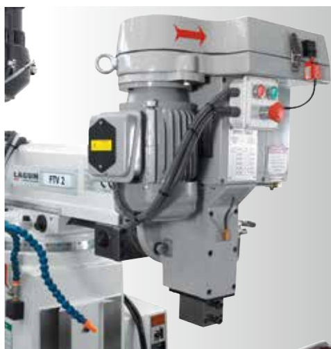
Mortajadora (curso 125 mm) Slotting attachment (travel 125 mm) Stoßapparat (Hub 125 mm) Appareil à mortaiser (course 125 mm)
