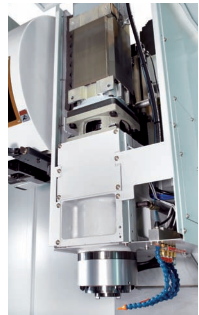
Motomandrino Direct-drive spindle Motorspindel Moteur broche
